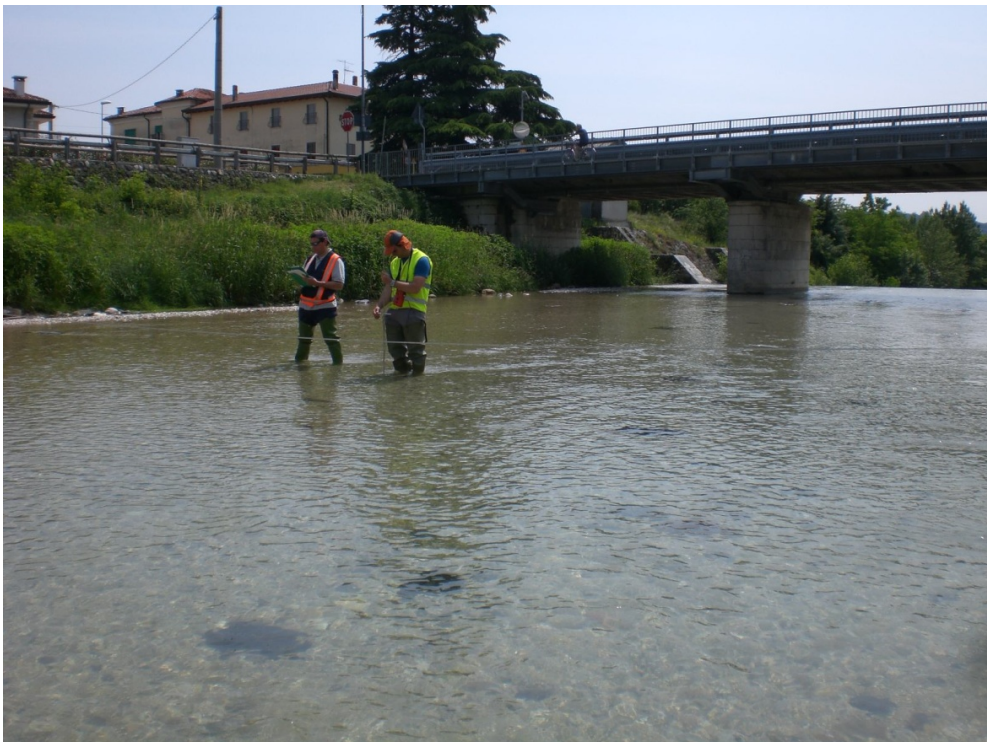
Figura 5 – Torrente Agno a Ponte Brogliano: misura di portata in condizioni di magra, eseguita a guado con l'impiego di un mulinello correntometrico
