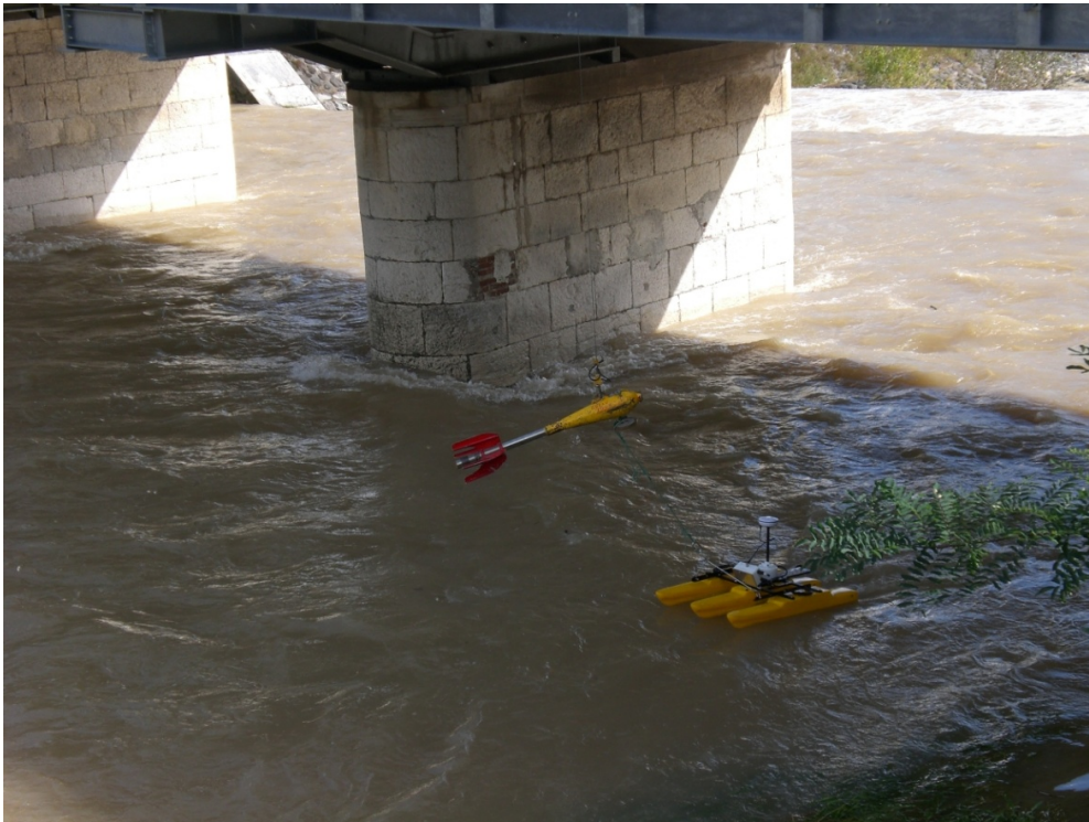
Figura 4 – Torrente Agno a Ponte Brogliano: misure di portata in condizioni di morbida e piena, mediante utilizzo di profilatore acustico Doppler (ADCP) montato su trimarano
