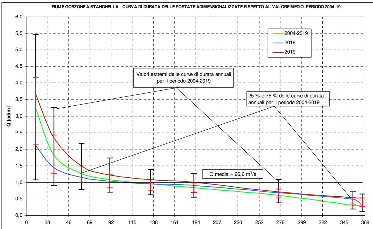
Figura 7 – Curva di durata delle portate per il fiume Gorzone a Stanghella, periodo 2004-19
