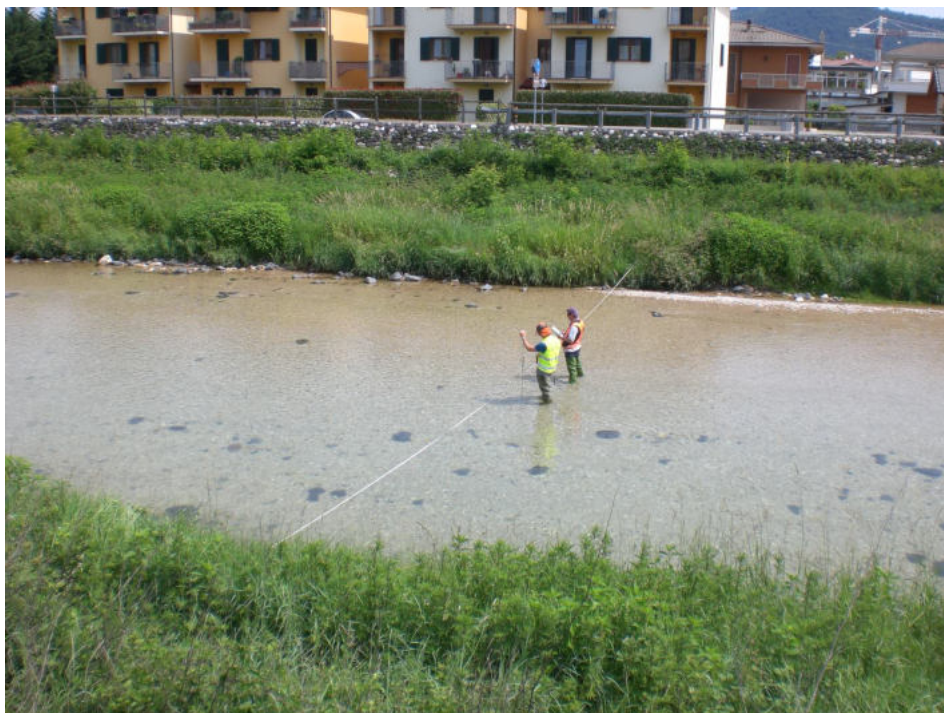
Figura 7 – Torrente Agno a Ponte Brogliano: misure di portata in condizioni di magra, eseguite a guado con l'impiego di un mulinello correntometrico
