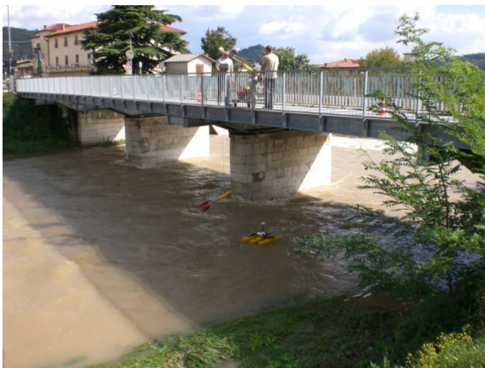
Figura 8 – Torrente Agno a Ponte Brogliano: misure di portata in condizioni di piena, utilizzando un profilatore acustico Doppler (ADCP) montato su trimarano
