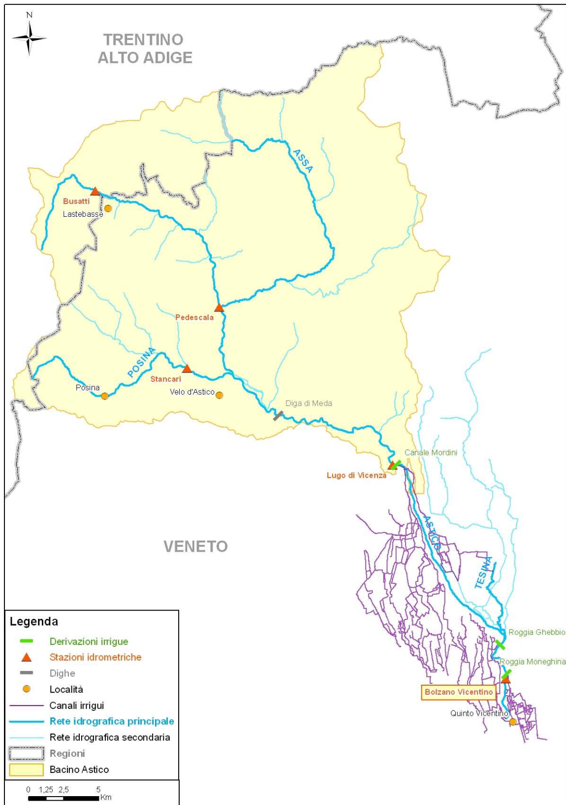
Tav. 1 – Bacino montano del torrente Astico: Schema idraulico delle principali derivazioni
