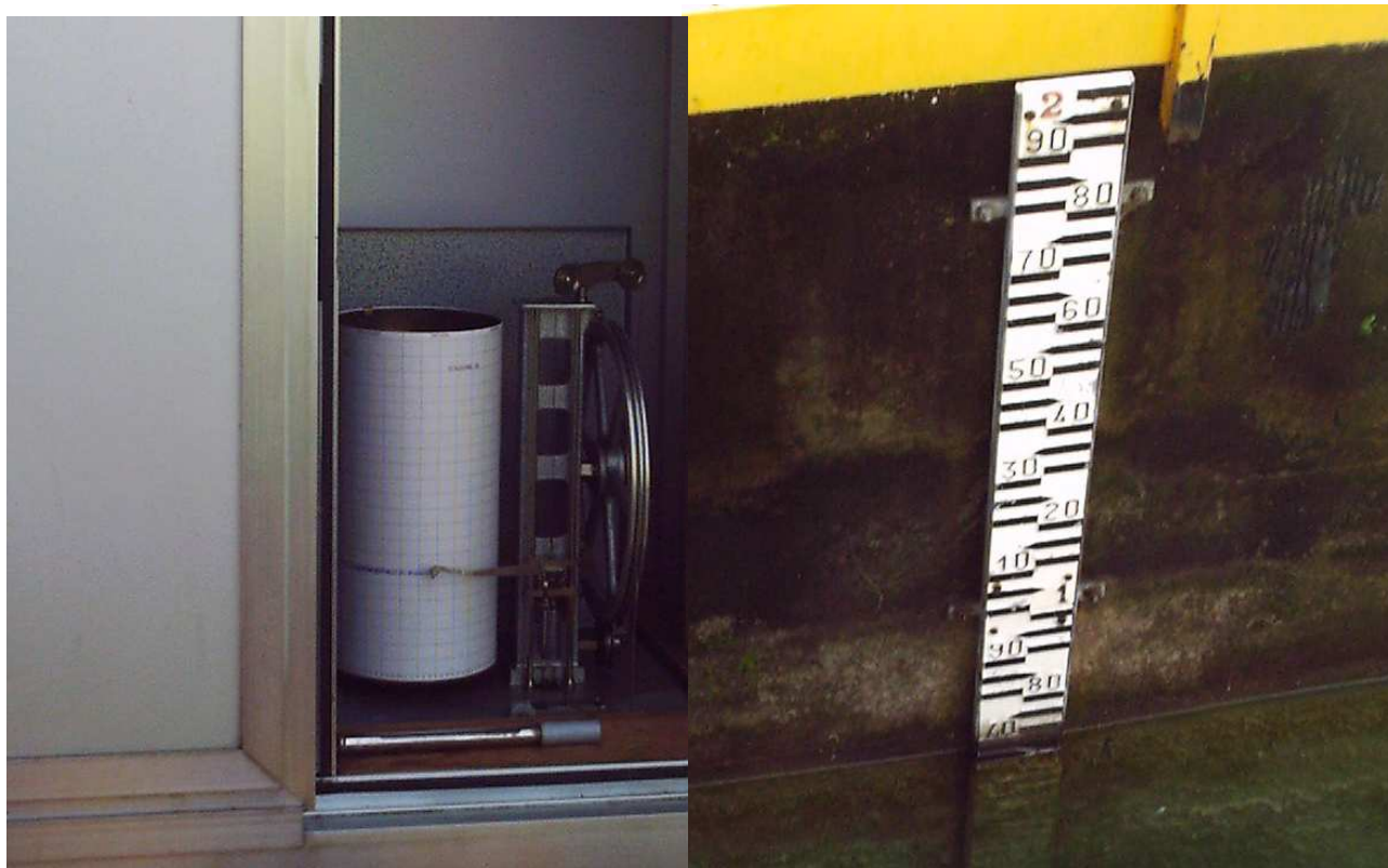
Foto 3 – Idrometrografo di Peschiera porta Verona Foto 4 – Asta idrometrica dell'idrometrografo
