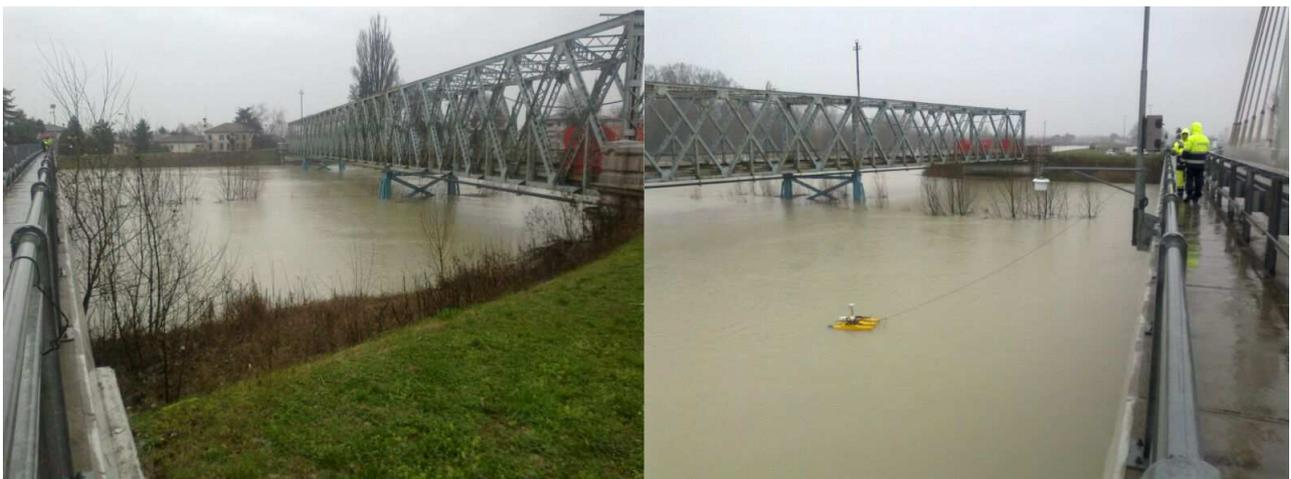
Figura 15. A destra immagine della sezione di Meduna di Livenza durante la piena di febbraio 2014. A sinistra fase di misura, sempre a Meduna di Livenza, con profilatore acustico dotato di sensore GPS.
