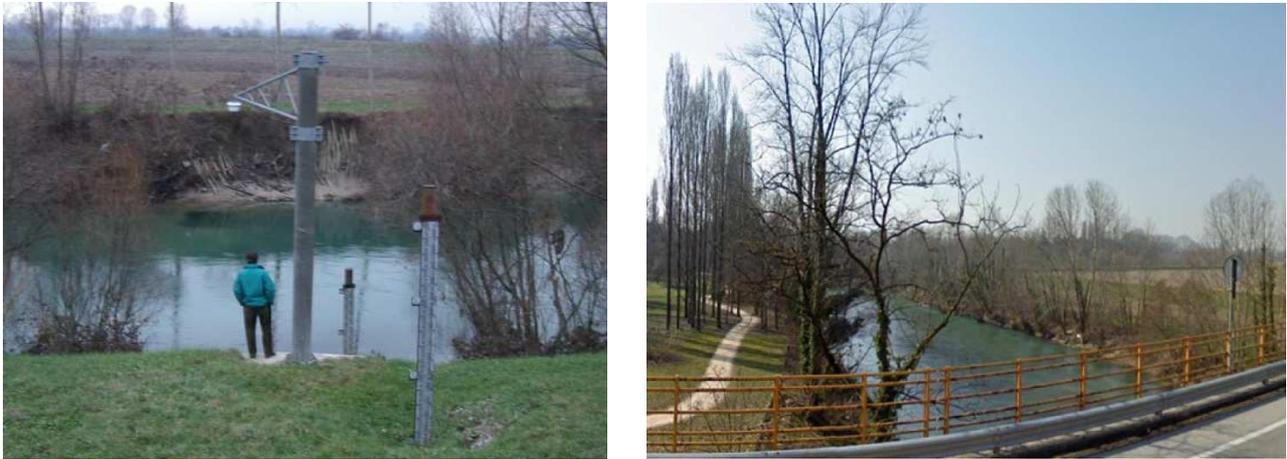
Figura 18. A destra idrometro di San Cassiano e asta idrometrica. A sinistra vista dell'alveo verso valle dal ponte di misura sulla SP 15 in località Brugnera (PN).
