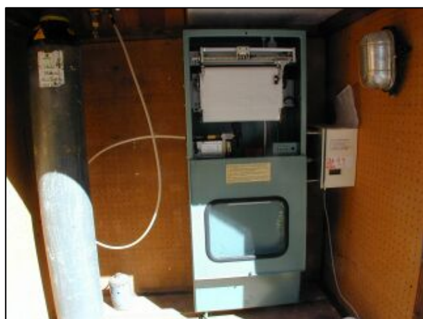
Foto 15 Teleidrometro a ultrasuoni e asta idrometrica
