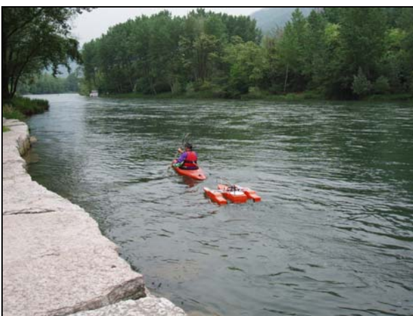
Foto 8 Misura con ADCP Rio Grande mediante canoa
