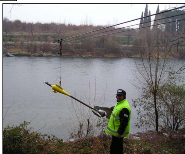
Foto 4 Mulinello con pesce zavorrato, calato mediante teleferica
