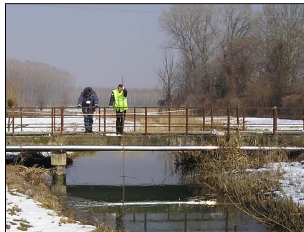
Foto 2 Misura da ponte con aste
