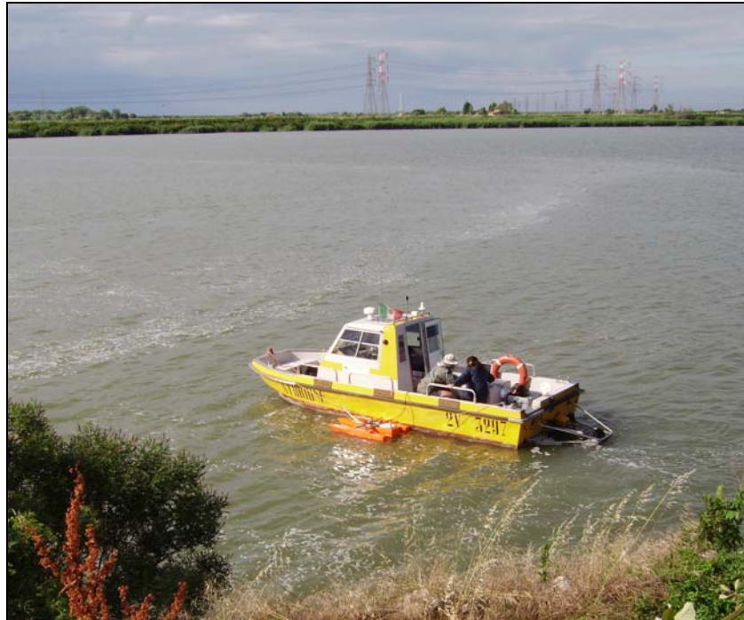
Foto 20 Misura sul fiume Po con ADCP fissata a imbarcazione
