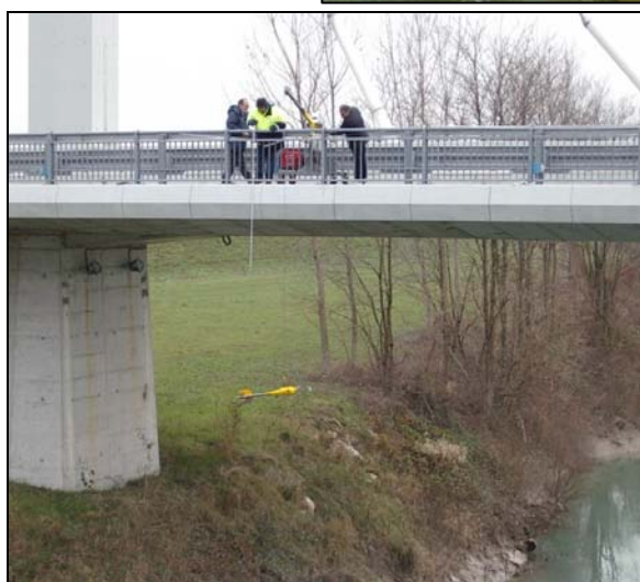
Foto 3 Misura da ponte con argano
