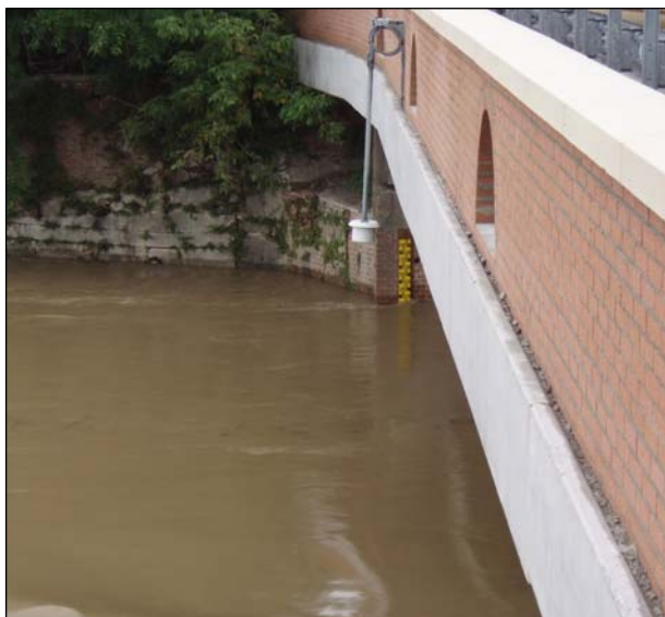
Foto 15 Teleidrometro a ultrasuoni e asta idrometrica
