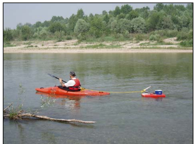
Foto 10 Misura con ADCP StreamPro mediante canoa
