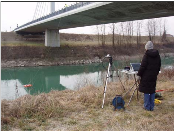
Foto 7 Misura con ADCP da ponte
