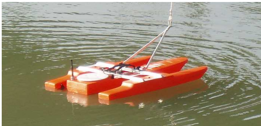
Foto 4 Strumentazione ADCP per tiranti di medio ordine.
