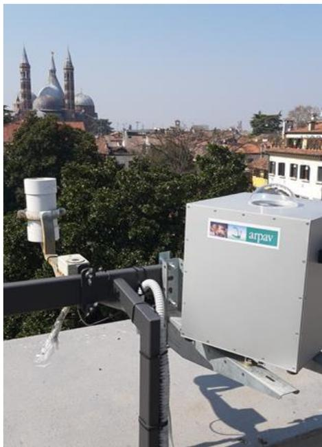
Figura 24: Spettrometro (a destra) accanto ad altri strumenti di monitoraggio del cielo notturno, stazione di Padova - ARPAV
