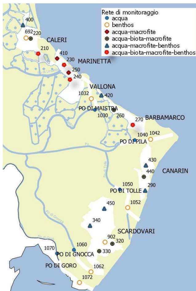
Fig. 2 - Mappa dei corpi idrici di transizione dei bacini del Po e del Fissero-Tartaro-Canalbianco con ubicazione delle stazioni di monitoraggio e dettaglio delle matrici monitorate.
