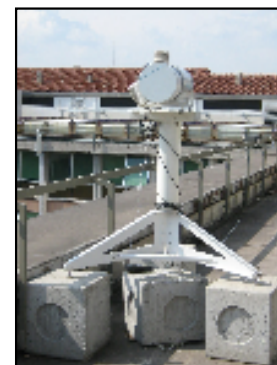
Verso l'alto. I profilatori: i nuovi strumenti meteo che consentono di sapere temperatura e vento ogni 50 metri fino ad un'altezza di 1000 metri
