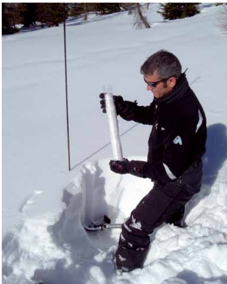
Fig. 8 Prelievo di una carota verticale di neve per la misura dello SWE.
