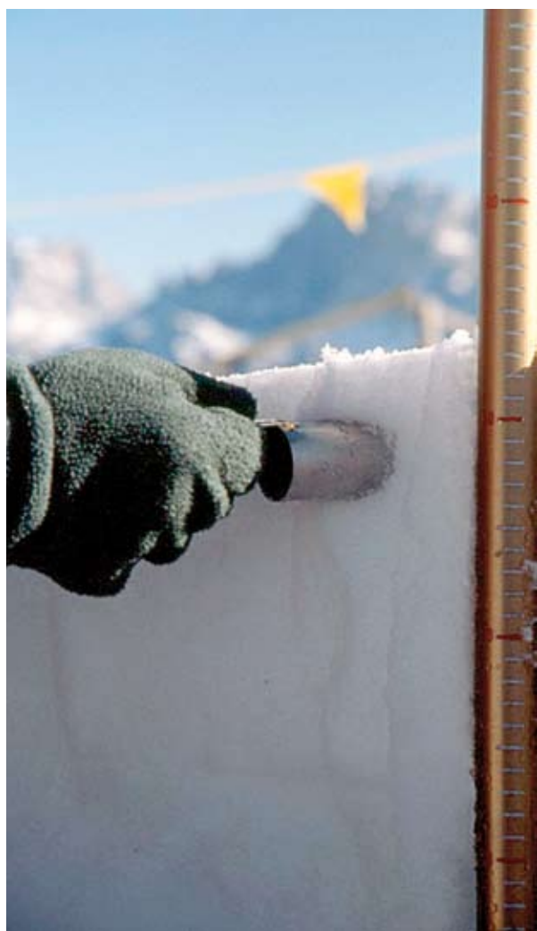
Fig. 5 - Determinazione della densità di uno strato di neve con un tubo carotatore dal piccolo diametro.
