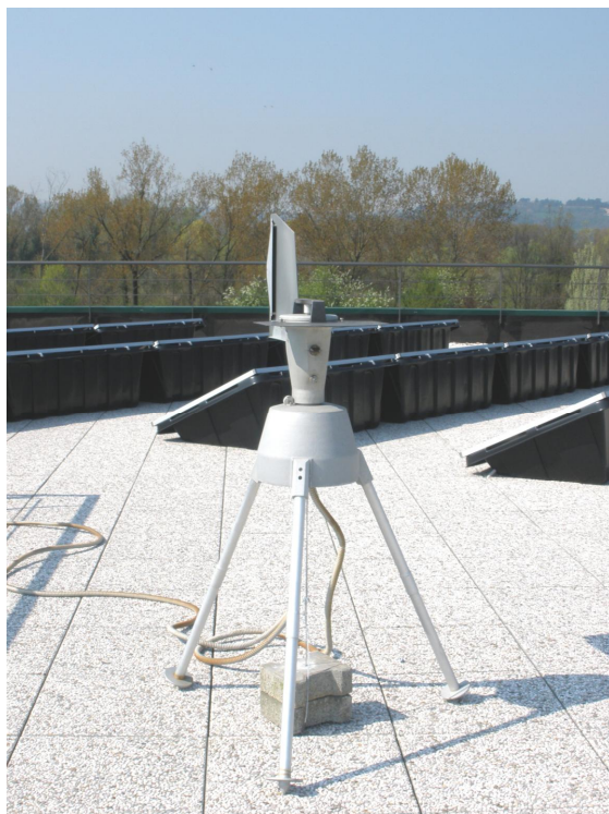
Figura 2. Campionatore VPPS 2000 (Lanzoni) – ARPAV, Dipartimento provinciale di Vicenza.
