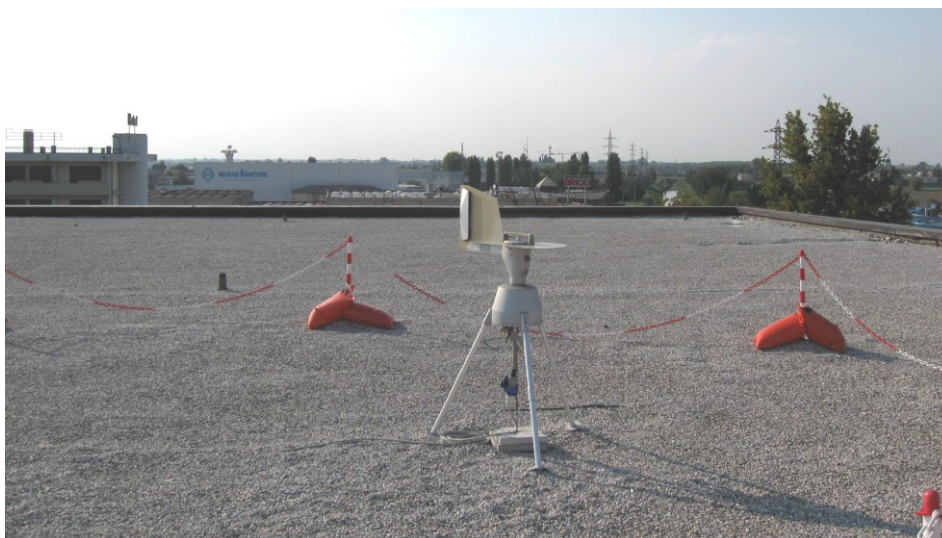
Figura 2. Campionatore VPPS 2000 (Lanzoni) – Dipartimento provinciale di Rovigo.
