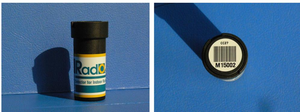
**Figura 2** – Dispositivi passivi a tracce modello Radosys utilizzati per la misura del radon.
