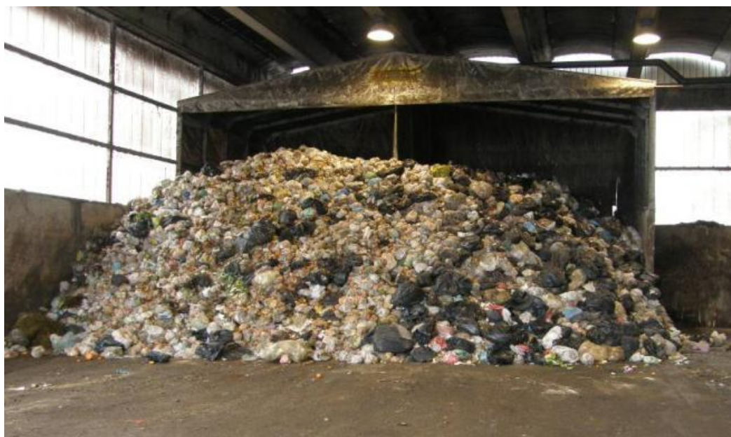
Figura 3.2.3 – Deposito di FORSU presso un impianto. Si osserva sulla sinistra il conferimento da raccolta domiciliare, mentre sulla destra il conferimento da parte delle grandi utenze.
