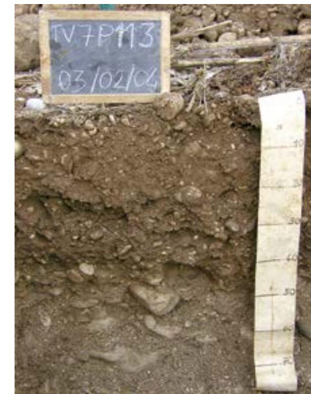
Fig. 5.12: I suoli ghiaiosi e poco profondi tipici dell'alta pianura recente. Il suolo della foto si è originato dalle alluvioni estremamente calcaree del Piave.
