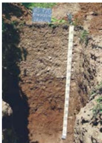
Una spessa copertura di materiale grossolano e inerte seppellisce il suolo preesistente; la conseguenza è la concentrazione delle radici in profondità.
