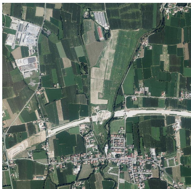
Fig. 2.19: Ripristino di un'area di 11 ha a Spineda nel comune di Fonte (TV), interessata dalla realizzazione di un bacino di laminazione in corrispondenza di una confluenza del torrente Musone con il torrente Lastego (immagine 2021 a sinistra, 2024 a destra).
