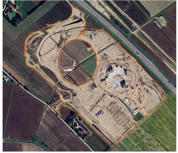
Fig. 2.14: Cantiere per la realizzazione del "Bosco dello Sport di Mestre. Il cantiere aperto nel 2024 occupa un'area di 27 ha. Il progetto prevede la costruzione di un palazzetto dello sport e di uno stadio in un'area di complessivi 116 ha, di cui 37 di superficie impermeabilizzata e 79 boscata (immagine 2023 a sinistra, 2024 a destra).
