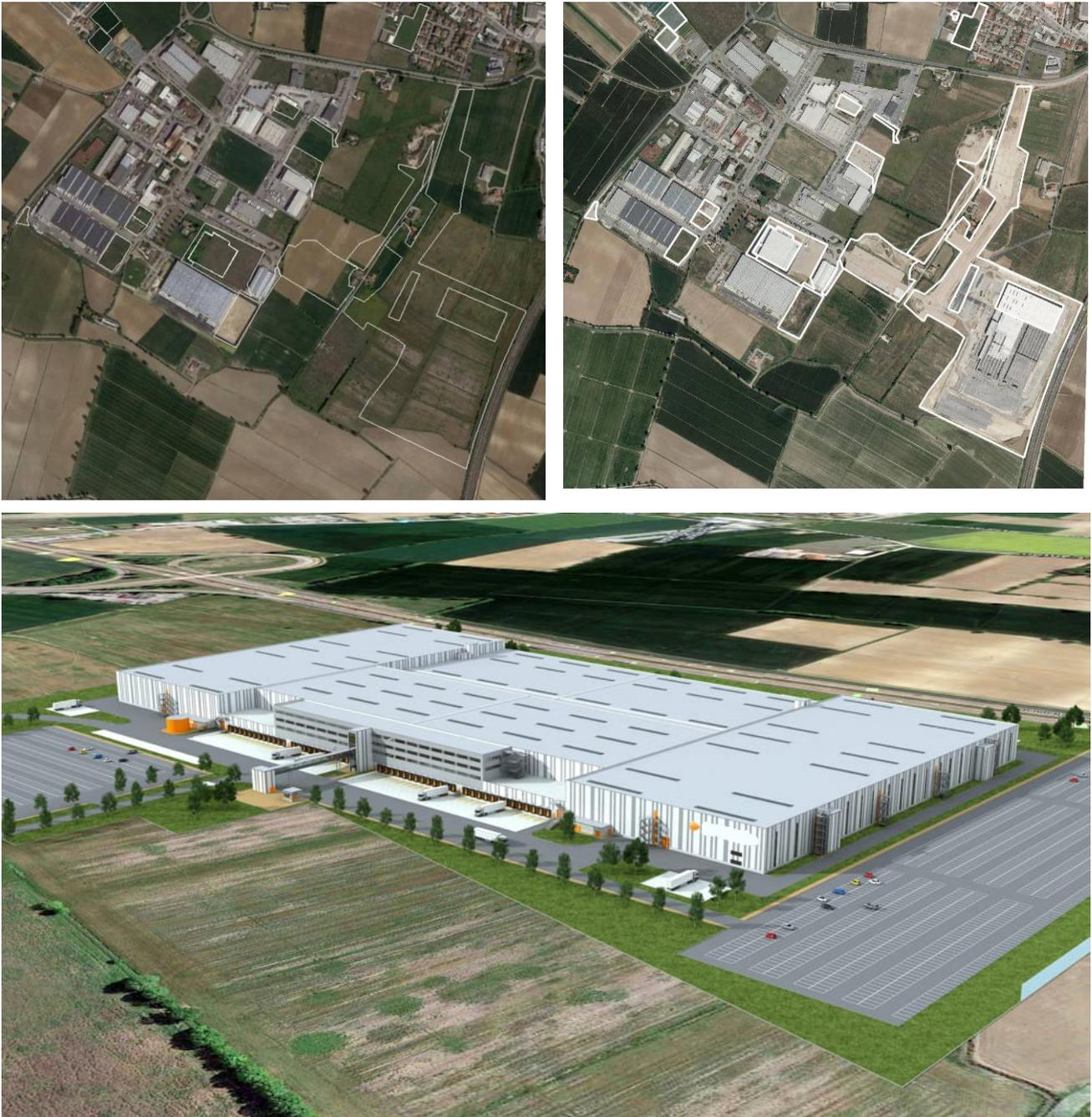
*Fig. 39: Magazzino di un colosso dell'e-commerce tedesco a Nogarole Rocca – VR; 150.000m<sup>2</sup> di magazzino, 20 ha area impermeabilizzata e 40 ha di superficie complessiva del cantiere (immagine 2017 in alto a sinistra, 2018 a destra, rendering in basso).*
