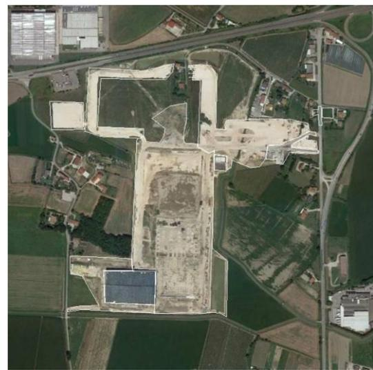
Fig. 33: Nuovo polo agro alimentare Agrologic - centro lavorazioni carni, centro di stoccaggio e distribuzione di prodotti agroalimentari - su una nuova area industriale a san Bortolo di Monselice (PD) di 300.000 m<sup>2</sup> di area complessiva con un'area coperta di 133.000 m<sup>2</sup> nelle previsioni (altezza 18m, 32m il silos), di cui risultano a cantiere 200.000 m<sup>2</sup> nel 2018 (immagine 2017 a sinistra e 2018 a destra).
