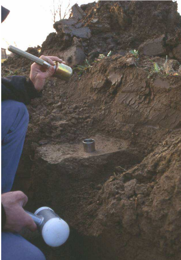
Fig. 1: Prelievo di campioni indisturbati con cilindri di volume noto.
