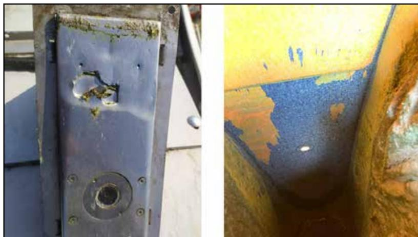
Figura 38. A SINISTRA: Usura della vaschetta di protezione utilizzata per l'installazione dello strumento Polispes NIR su trincia-caricatrice; A DESTRA: nuovo sistema di installazione dello strumento Polispes NIR con riduzione della superficie esposta ad usura.
