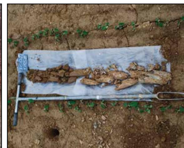
Figura 10. Trivella di tipo olandese per l'estrazione manuale di carote di terreno.
