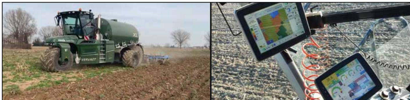
Figura 4. Interratore semovente per la distribuzione della frazione chiarificata (sx) equipaggiato con dispositivi per la distribuzione di precisione (dx).
