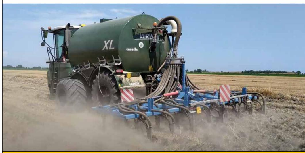
Figura 41. SOPRA: Visuale della botte semovente che esegue il carico di digestato e la relativa misura; SOTTO: la stessa macchina intenta nello spandimento ed interrimento del digestato in campo.
