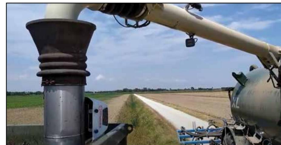
Figura 39. Dettaglio dell'installazione dello strumento Polispes NIR sulla bocca di carico della "balia".
