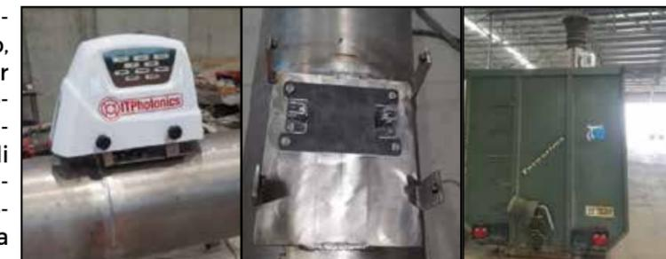
Figura 2. Sensore NIR e suo posizionamento nella vasca balia.
