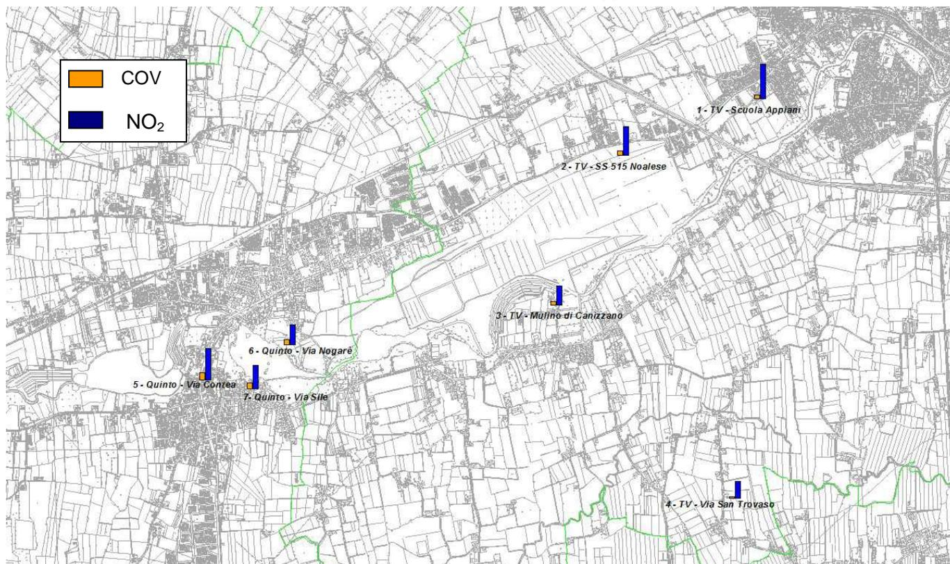
**Figura 2** Concentrazioni medie del periodo di monitoraggio di COV totali e NO<sub>2</sub> nei siti in prossimità dell'Aeroporto Canova
